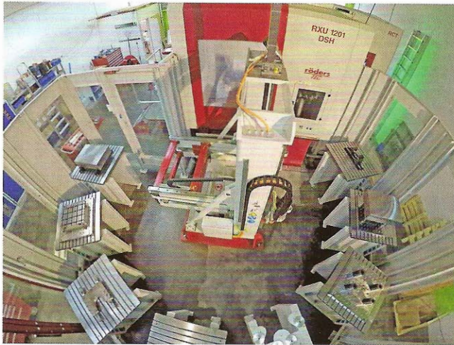
Bild 4: Mit dem Palettenwechsler RCH2 mit insgesamt sieben Plätzen kann das Fräsbearbeitungszentrum an Wochenenden 60 Stunden ohne Unterbrechung durchgearbeitet werden.
