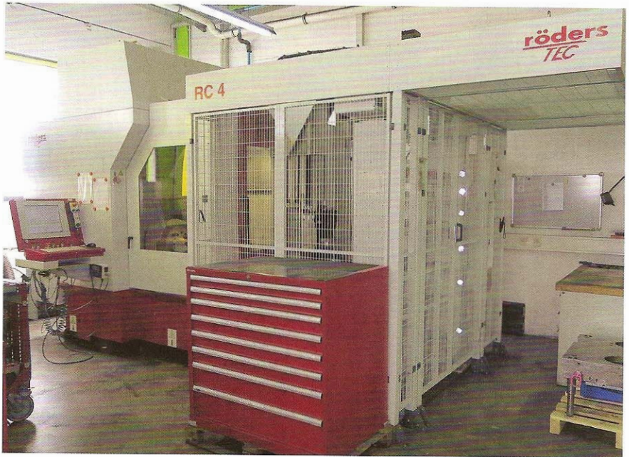
Bild 9: Die fünfschige Rödgers RXP 600 DSH mit ihrer Automation RC4 bewährt sich seit 2011 beim Fräsen von Graphit und Werkzeugstahl (Bilder 1 bis 5, 9: appexx)
