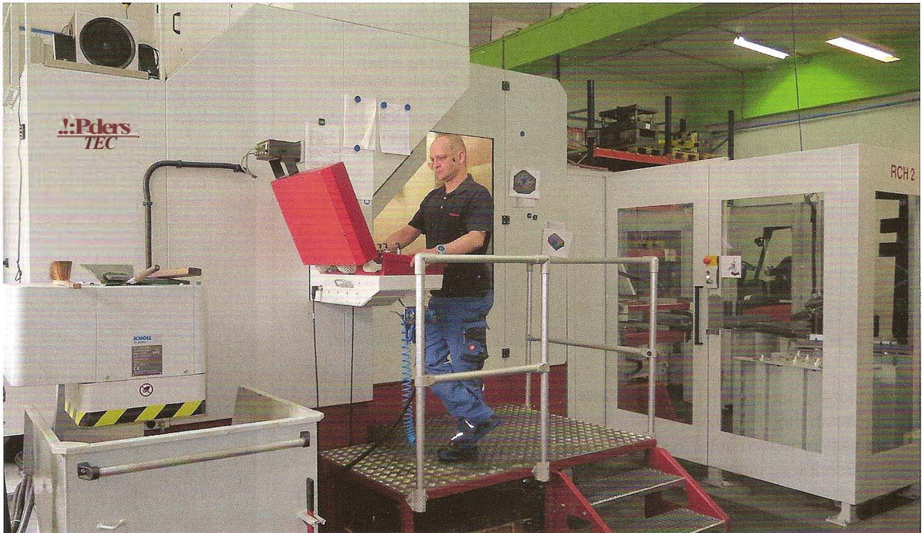
Bild 1: Die vor zwei Jahren installierte Rödgers RXU 1201 DSH. Rechts im Hintergrund der 7fach-Palettenwechsler RCH2
